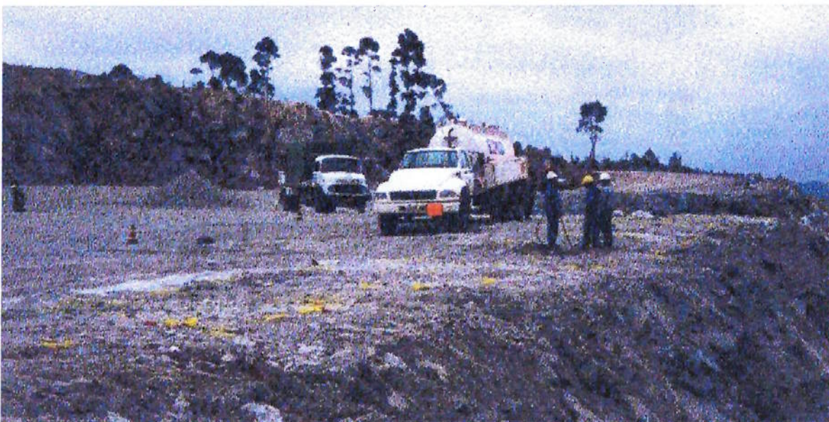
Foto 6 - carregamento mecanizado de emulsão
