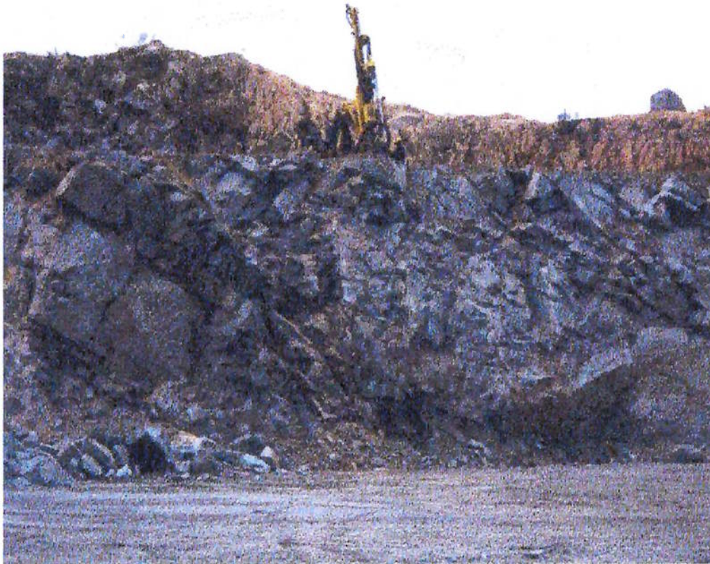
Foto 3 - visão da parede da frente 6B1 muito fissurada -
