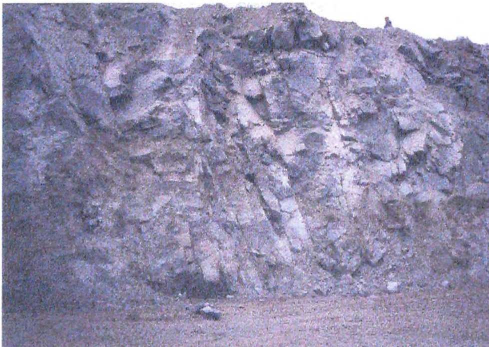
Foto 4 - visão da parede muito fissurada da frente 5B1
